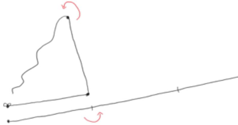
Fijas un extremo de la cuerda con un clavo. Pones otro clavo después de la primera marca —es decir, después de la marca de los 60 o después de 3 pedazos, depende de tu cuerda. La cuerda se dobla cuando pasa por el segundo clavo. Pones el tercer clavo en el único punto —hay un único punto— que permite cerrar el triángulo. El triángulo que resulta es rectángulo y ahí tienes tu esquina.
